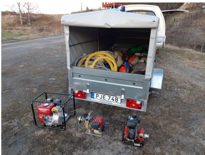
Brandvärnets skogsbrandskärra med slangar och bärbara pumpar är en viktig resurs för att kunna komma snabbt iväg med all nödvändig utrustning om larmet går att skogen brinner.
