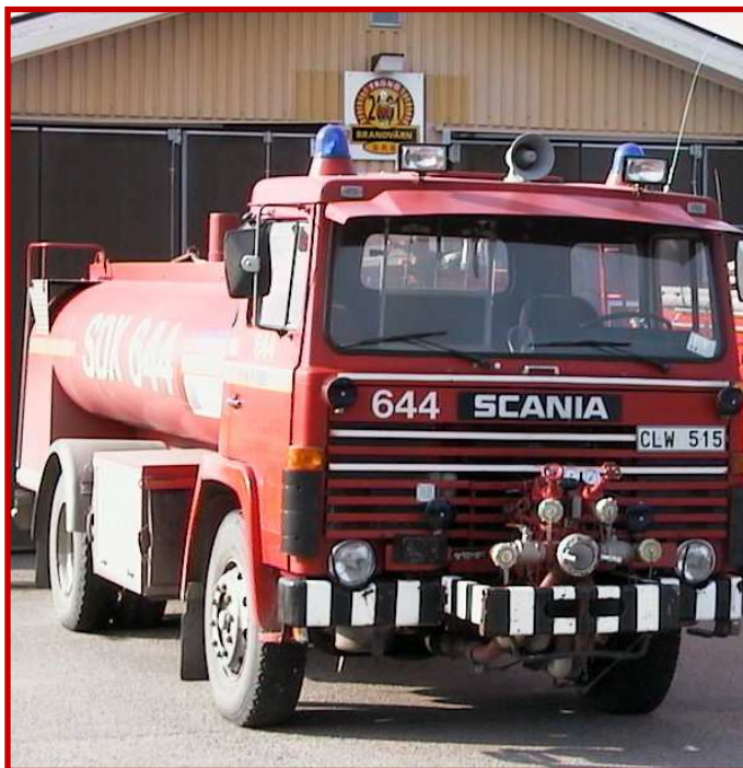
Tankbilen, en Scania LB 81 från 1976 med 7,5 m 3 vattentank, lider av ålderskrämpor som skulle vara för kostsamma att åtgärda. Det krävs körkort för lastbil för att få ratta den. Brandvärnet vill istället satsa på en mindre utryckningsbil avsedd för B-körkort.
